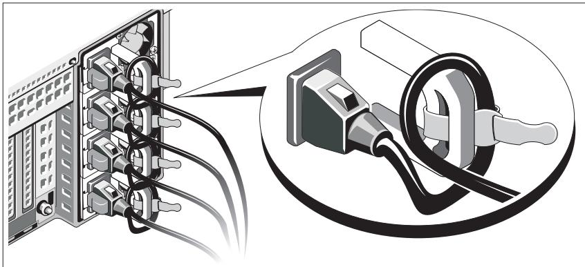
如图所示，将系统电源电缆弯曲成一个环路，并使用所提供的腕带将其固定到支架。
